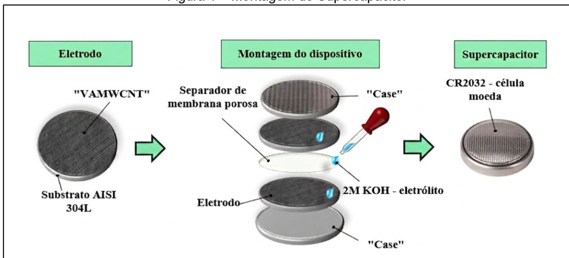
Figura 1 – Montagem do Supercapacitor
