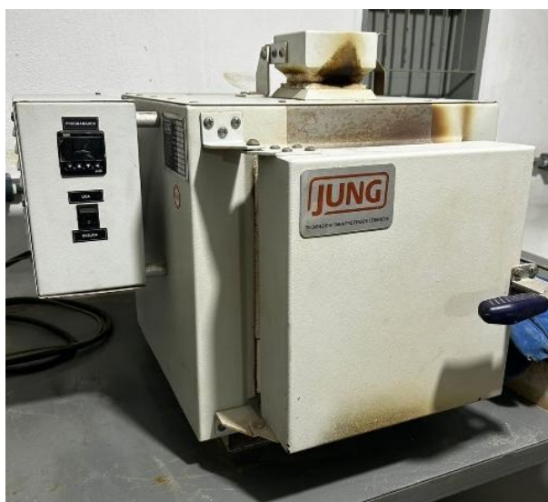
Figura 3 – Mufla Jung Modelo LF 06 12
