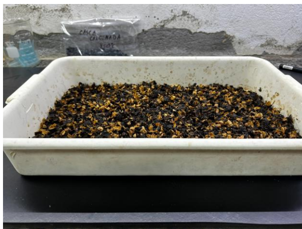
Figura 10 – Casca de café após a secagem: redução de umidade e mudança de aspecto visual
